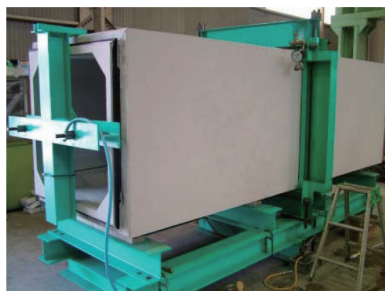
継手部水密性能試験 (ゴムリング方式)
